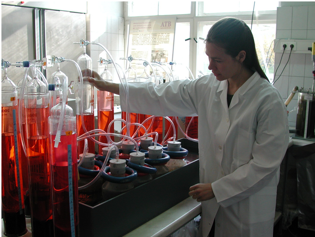
Abb. 2: Ablesung der Biogasmenge bei Gärtests (Foto ATB)
